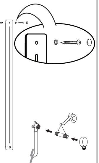
Placez vis et capuchon de finition, vissez solidement la barre murale. Installez le raccord coudé.
