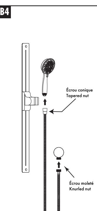
Raccordez le boyau. Alignez soigneusement les filets. Serrez fermement à la main. Ne serrez pas trop fort. **N'utilisez pas de clé à molette ou une pince.**
