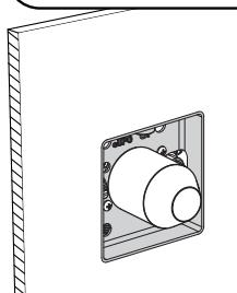
La valve doit être installée afin d'avoir le gabarit de perçage à égaleit avec la céramique. Laissez le gabarit de perçage et le protecteur #4b en place à l'installation pour éviter d'endommager le fini de la valve.
