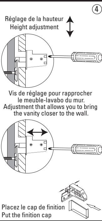
**4.** Servez-vous des vis de réglage comprises avec les supports du meuble-lavabo pour en régler la hauteur et le rapprocher du mur.
