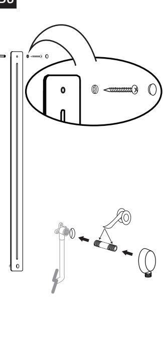
Placez vis et capuchon de finition, vissez solidement la barre murale. Installez le raccord coudé.
