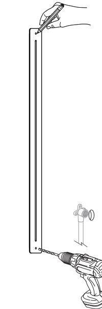
Avant de percer la cloison, placez le produit contre le mur pour marquer l'emplacement des trous. Utilisez une mèche appropriée pour percer votre mur.
