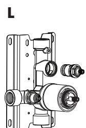
To replace the check valve or the shut-off valve • Pour remplacer la soupape anti-retour ou la soupape d'arrêt
